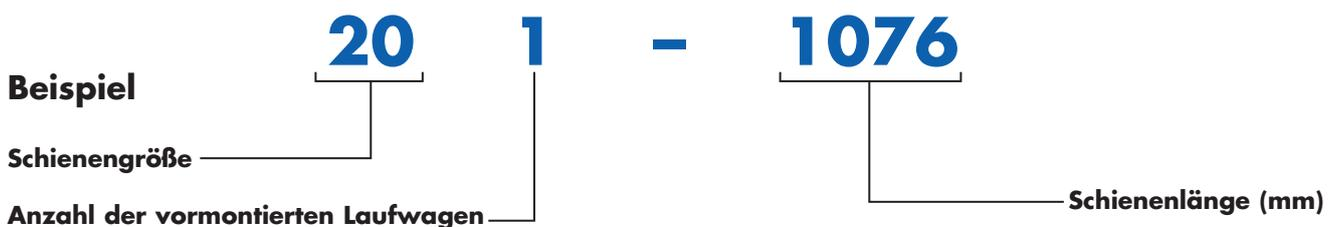
Einheiten werden montagefertig mit bereits voreingestellten Laufwagen geliefert.
