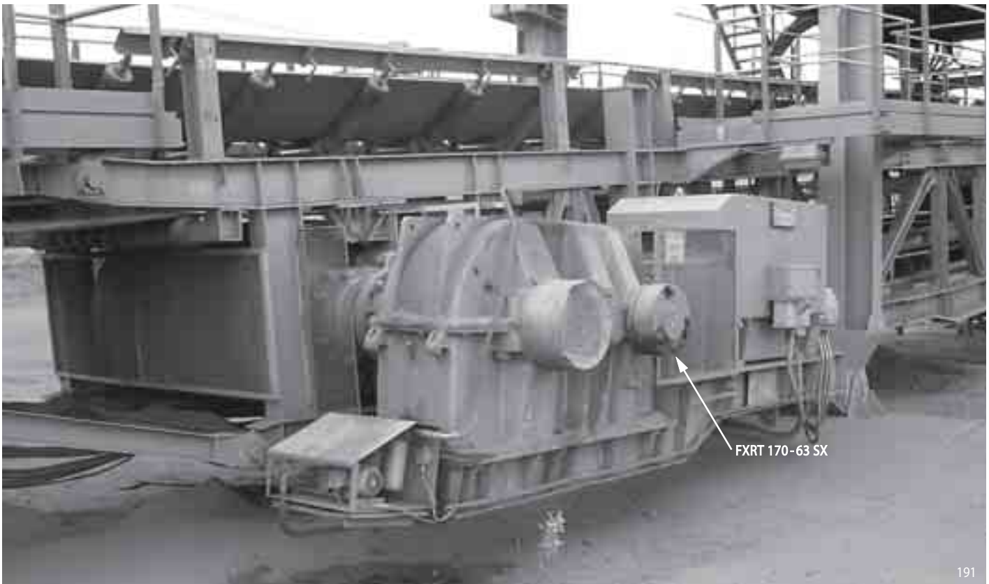
Bandanlage zur Förderung von Eisenerz in Südafrika; angetrieben von drei Getrieben mit RINGSPANN Rücklaufsperrern FXRT 170-63 SX.
