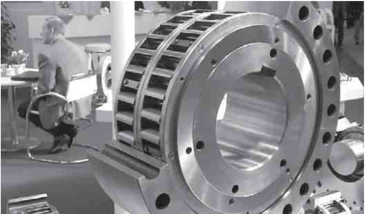
Rücklaufsperre FXM 2.410-100 UX für die primäre Kühlwasserpumpe in einem Kernkraftwerk. Erforderliches Drehmoment 500 000 Nm, Drehzahl 1 485 min -1 . Seit 1996 im Einsatz. Gefertigt und getestet mit einer umfassenden Dokumentation von RINGSPANN GmbH, Bad Homburg.
